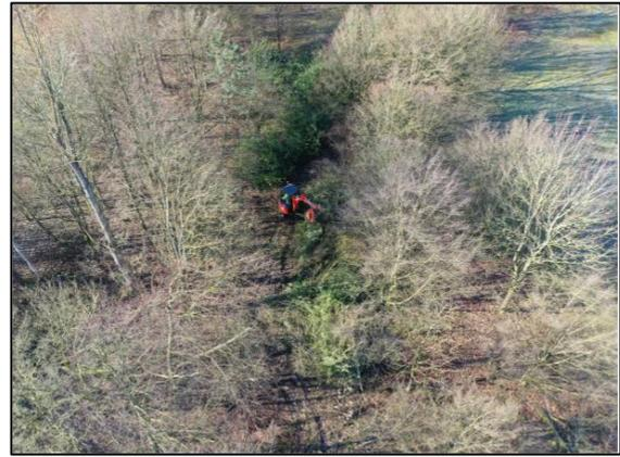
Links: Minibagger mit Fällgreifer, der den Feuerdornbestand büschelweise abkneift, ohne zu zerkleinern.
