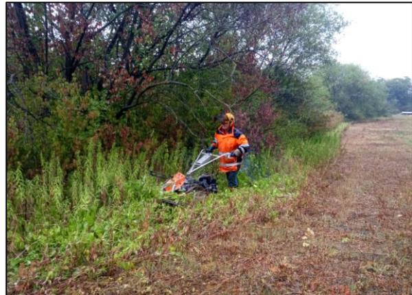
Aufnahme des eigens für uns umgebauten und mit einer speziellen Vorrichtung ausgestatteten Balkenmähers (links) im Einsatz (rechts).
